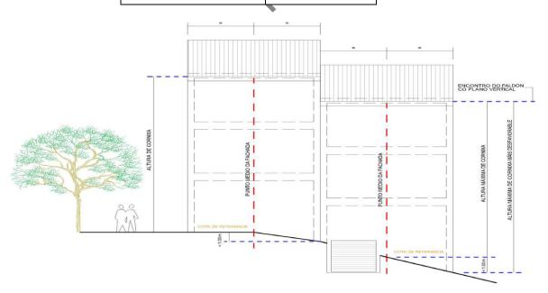
3. Para los casos en los que se construya sobre terrenos en pendiente, la longitud de las fachadas o el fondo de la edificación se tendrá que dividir en las partes necesarias, escalonando convenientemente la altura, como si establece en el Reglamento de la Ley del suelo.
