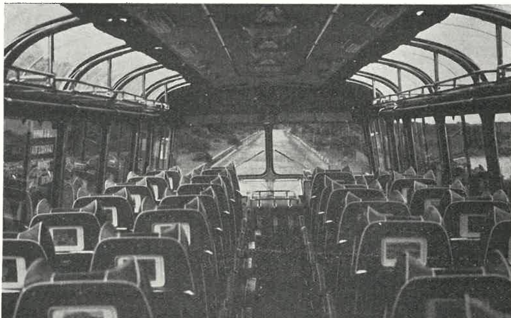
Omnibus totalmente metálico—1961. Con butacas reclinables, cobillos en el techo para máxima visibilidad. Equipo de calefacción y radio
