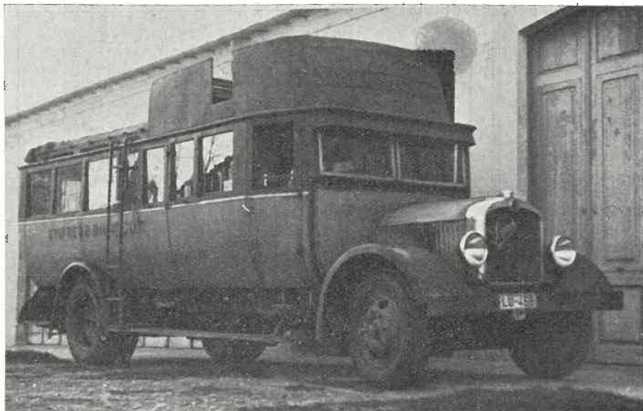
Carrocería semi-metálica (madera y chapa), fabricada en 1925
