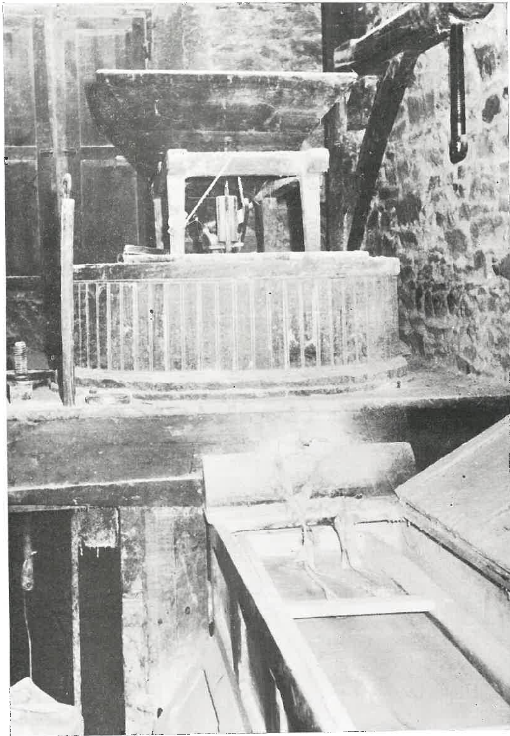
Aspecto del interior de uno de los molinos típicos, en los que pueden apreciarse O TREMINADO, con la tolva para el grano y A COCINA, zócalo de piedra en el que se asientan AS MOAS y los otros elementos de la molienda
